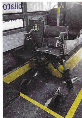
Au sol, la ligne jaune matérialise le tracé à suivre. Un emplacement est dédié au rollateur, et les pictogrammes sont apposés directement sur les sièges réservés aux personnes vulnérables.
