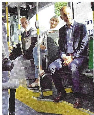
Le Pr Christian T. Haas, chercheur à l'institut Fresenius, occupe un des sièges surélevés placés sur une estrade. Cet aménagement a permis de ne pas modifier la hauteur de l'assise, qui est réglementée.
