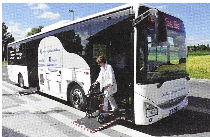
Grâce à une double porte et une rampe, les personnes munies de rollateur peuvent monter et descendre par l'avant du bus.
